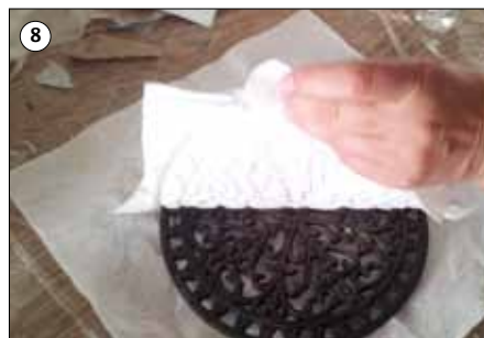
8 Tag støbning forsigtigt af formen.
