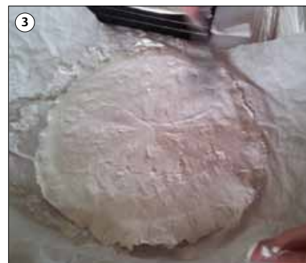
3 Kom et tykt lag ReliefBase bag på støbningen.
