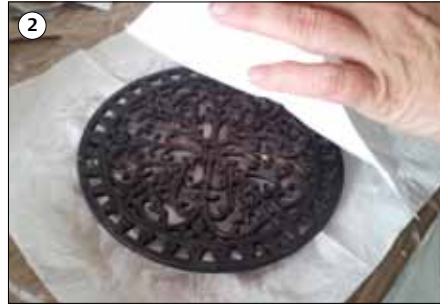
2 1.lag – læg en papirserviet på støbeformen.
